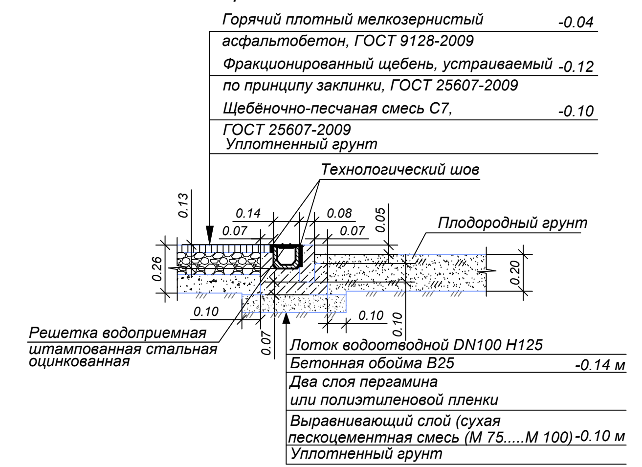
Сечение водоотводного лотка закрытого типа DN100 H125
